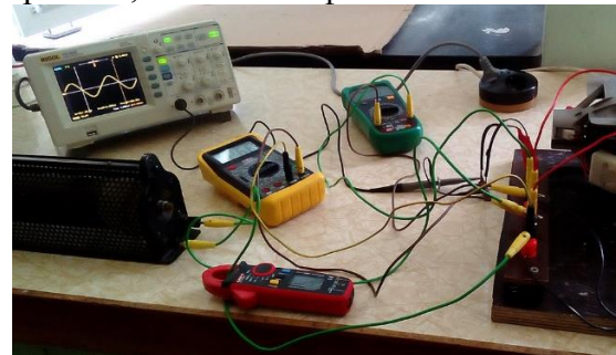
Фиг.3. Снимка от лабораторния стенд в процес на отчитане оборотите чрез тахогенератор (показано на осцилоскопа)
