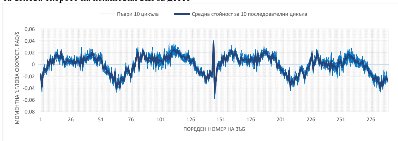
Фиг. 1 Крива на моментната ъглова скорост на колянния вал за десет последователни цикли при изправен двигател
