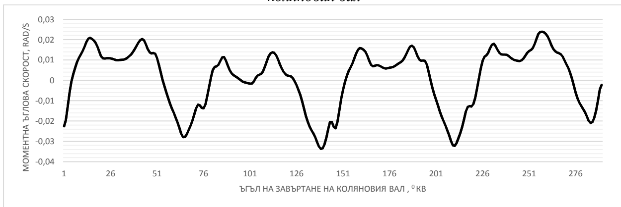
Фиг. 2 Моментна ъглова скорост на изправен двигател след обработка на сигнала по метода на пълзящо усредняване
