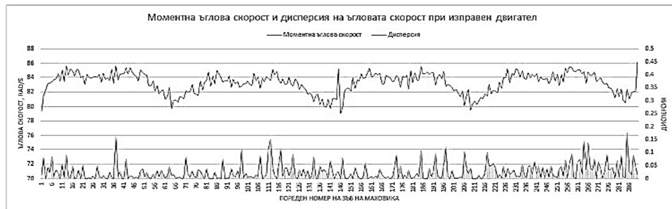
Фиг. 2 Усреднени стойности на моментната ъглова скорост и дисперсията от десет последователни цикли при изправен двигател
