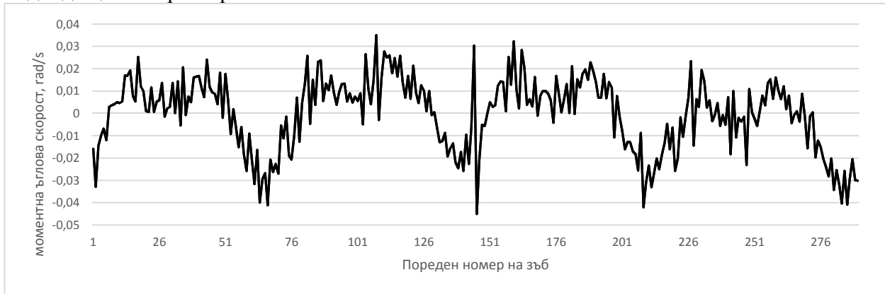
Фиг. 1 Характеристика на измерената и нормализираната моментна ъглова скорост на коляновия вал
