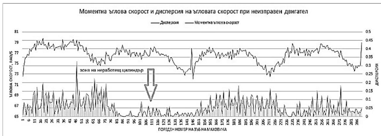
Фиг. 3 Усреднени стойности на моментната ъглова скорост и дисперсията от десет последователни цикли при неизправен двигател (неработещ един цилиндър)
